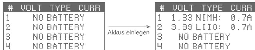
4. Drücken Sie die entsprechende blinkende Ladefachaste. Der entsprechende Stromwert blinkt im Display um anzuzeigen, dass der Wert nun eingestellt werden kann. Drücken Sie ▲ oder ▼ um den gewünschten Wert zu wählen. Drücken Sie ENTER um den Ladevorgang zu starten.
